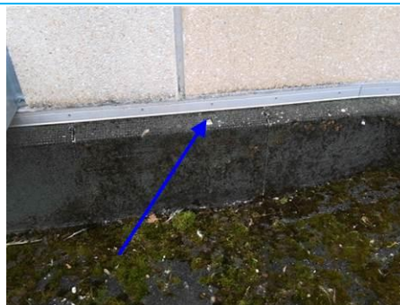
Matériaux : ZPSO-027 Prélèvement : P044 Description : Relevé : revêtement bitumineux (bandes, lés...) Localisation : Toiture terrasse - CB T026 Résultat : Absence d'amiante
