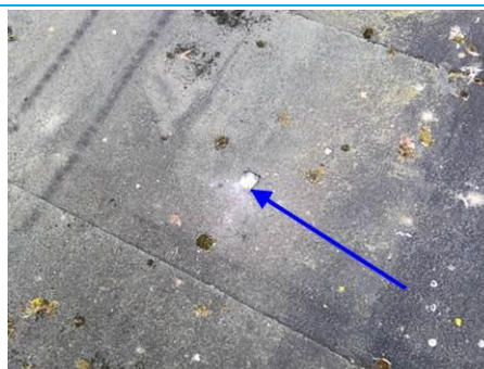
Matériaux : ZPSO-023 Prélèvement : P034 Description : Partie plane : revêtement bitumineux (bandes, lés...) Localisation : Toiture terrasse - CB T026 Résultat : Absence d'amiante
