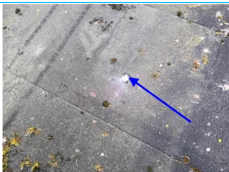
Matériaux : ZPSO-024 Prélèvement : P035 Description : Partie plane : Béton Localisation : Toiture terrasse - CB T026 Résultat : Absence d'amiante
