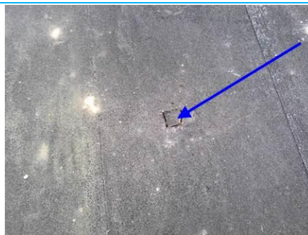
Matériaux : ZPSO-021 Prélèvement : P032 Description : Partie plane : Colle bitumineuse Localisation : Toiture terrasse - CB T015 Résultat : Absence d'amiante
