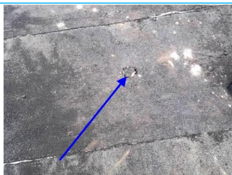
Matériaux : ZPSO-003 Prélèvement : P007 Description : Partie plane : Colle bitumineuse Localisation : Toiture terrasse - CB T024 Résultat : Absence d'amiante
