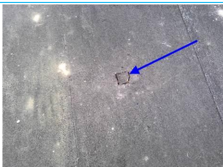
Matériaux : ZPSO-022 Prélèvement : P033 Description : Partie plane : Béton Localisation : Toiture terrasse - CB T015 Résultat : Absence d'amiante
